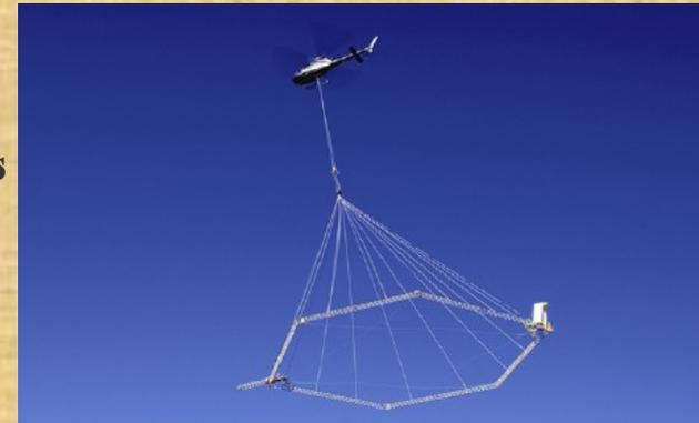
Оценивание систем по моделированию с учетом геометрии (высота, положение передатчик-приемник), формы сигнала, временных окон и удельных электропроводностей целевых, перекрывающих и вмещающих пород.
